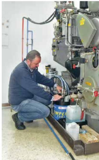
El kit de ensayo MAXICHECK Pure Power contiene todo lo necesario para realizar un control de disolvente a pie de máquina, de forma fácil y fiable.
